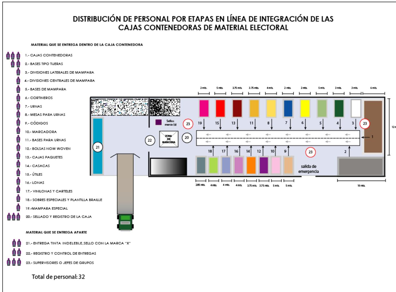
Se usarán las bandas transportadoras de rodillos de gravedad para el desarrollo del proceso de integración de las cajas contenedoras de material electoral y la distribución del personal en la banda se realizará por etapas de armado.
